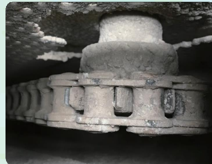
行业: 肥料生产行业 设备名称: 肥料运输设备 使用环境: 肥料粉尘，海岸区
