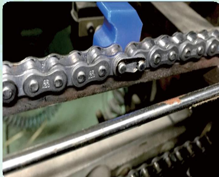
行业: 造纸行业 设备名称: 造纸输送设备 使用环境: 无润滑油，纸尘
