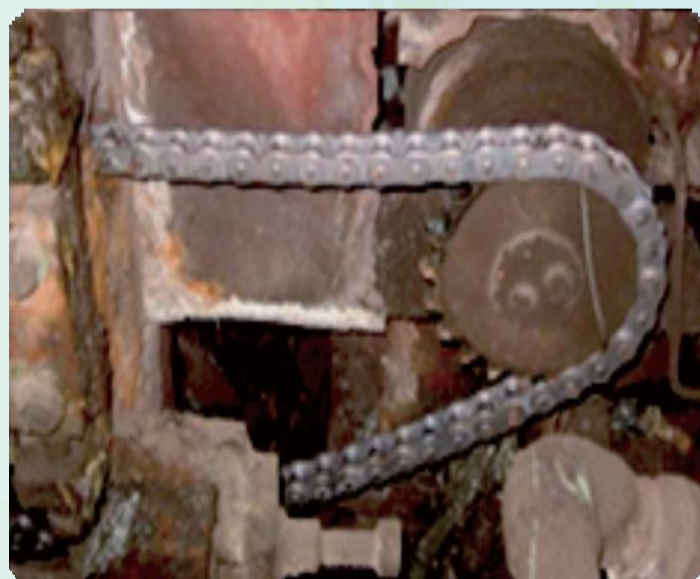
行业: 冶金行业 设备名称: 钢铁生产线设备 使用环境: 水蒸气，粉尘，高温
