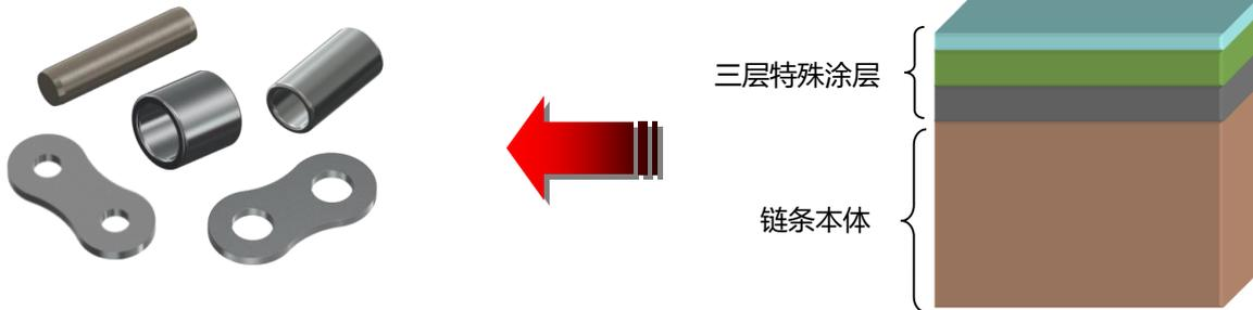
对销轴，套筒，滚子和链板，每个个体进行表面处理，与链条装配后进行的整体表面处理方法相比，这种新方法使零件内部都得到均一的表面处理。
