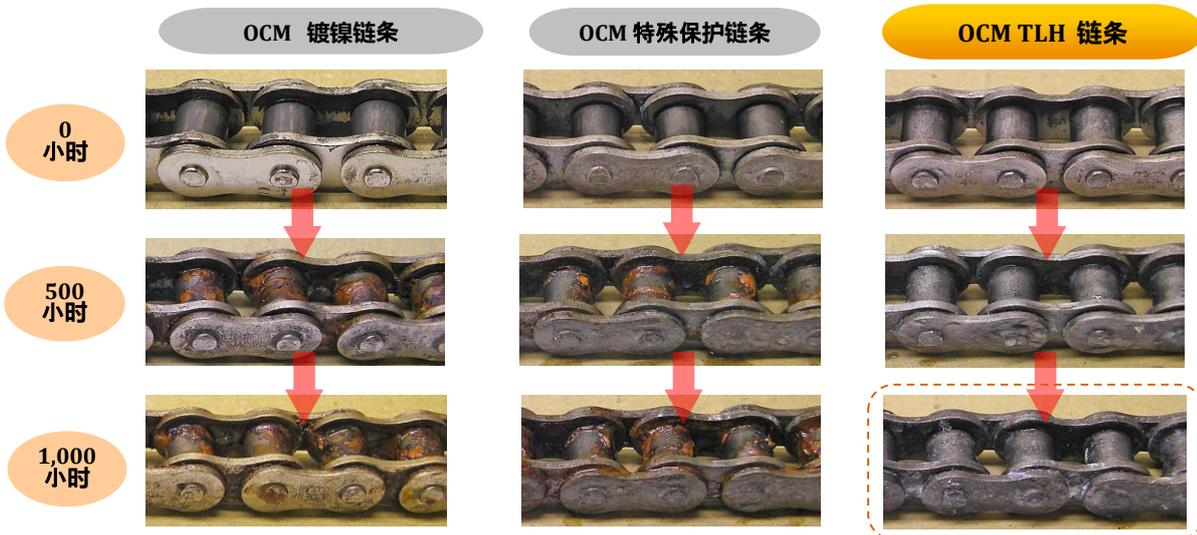
对长时间持续运行的链条进行盐水喷雾测试，1000小时后，链条表面也没有生锈。在牢固的贴合性和自我修复能力的相互作用下，TLH链条具有超强耐腐蚀性。
