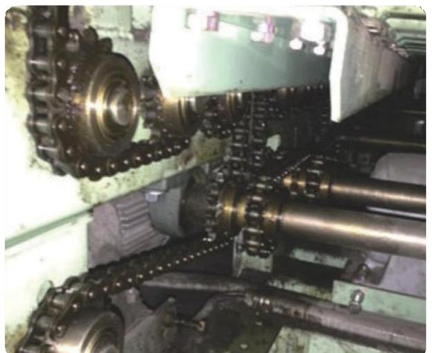
注意：请不要给链条加水 and 加油。随着水和油在链条上流动，可能会带出套筒内部的油，最终导致链条生锈，磨损加剧。
