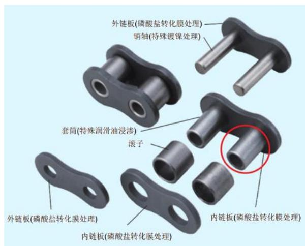
SELUBE自润滑链条可代替ANSI标准滚子链。运行温度范围应在-10℃到150℃。链条运行速度应保持在150米/分以下。
